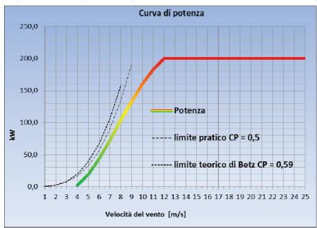
L'impianto produce mediamente circa 550.510 kW/h annui (con 6 m/s di media annua a 25 m slt e uso di una torre da 30 metri). In questa condizione il generatore può rendere circa 165.150 euro annui che possono arrivare anche a oltre 358.000 euro annui se il sito scelto è fortemente ventoso (con 12 m/s di ventosità media annua a 25 metri slm), in queste condizioni raramente raggiungibili\* la produzione di energia elettrica potrebbe infatti superare 1.116.000 kWh/anno!
