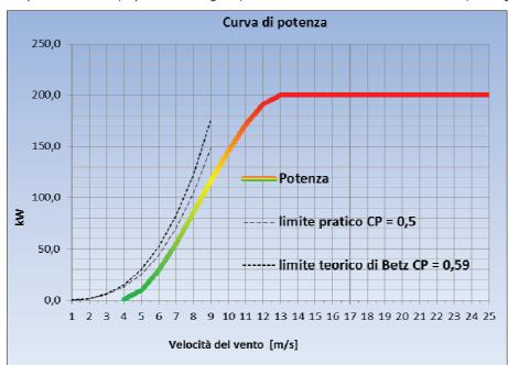
L'impianto produce mediamente circa **449.460 kW/h annui** (con 6 m/s di media annua a 25 m slt e uso di una torre da 30 metri). In questa condizione il generatore può **rendere circa 134.840 euro annui** che possono arrivare anche a oltre **328.000 euro annui** se il sito scelto è fortemente ventoso (con 12 m/s di ventosità media annua a 25 metri slm), in queste condizioni raramente raggiungibili\* la produzione di energia elettrica potrebbe infatti superare **1.093.000 kWh/anno!**
